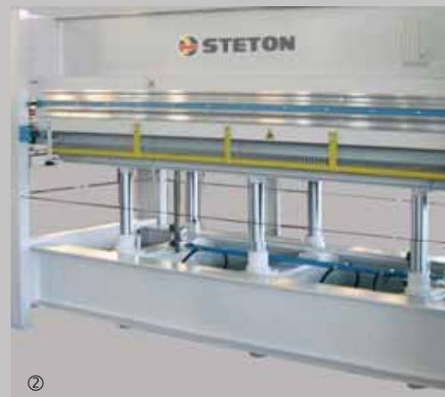
A richiesta, le prese possono essere dotate di barriere di protezione a rete metallica e/o fotocellule di sicurezza.
