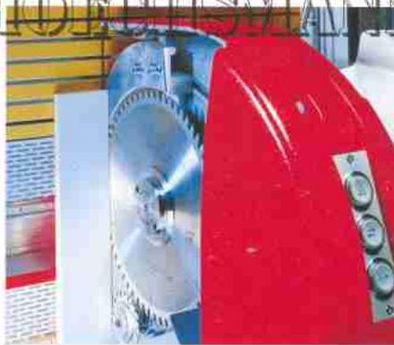
sägeblattes verlängert sich durch den Einsatz des VSA um das 7-8fache. Ein Vorritz-Sägeblatt übersteht den Einsatz von mind. 3 Hauptsägeblättern. Ohne VSA-Einsatz würden für die gleichen Laufmeter verleimfertiger Kanten fast 25-mal so viele Hauptsägeblätter benötigt.
