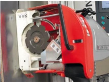
Bei vielen Aufträgen sind Nut- oder Fräsarbeiten notwendig. Diese können auf einer EVOLUTION ohne Probleme ausgeführt werden. Sie können Holzwerkstoffe und Verbundplatten fräsen und nuten.
