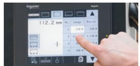
Masse eintippen, fertig. Das Elektronische-Positioniersystem EPS ist vollständig in das Touch-Screen Panel integriert. Es erlaubt die einfache und auf den 1/10 mm genaue Positionierung der horizontalen x-Achse.
