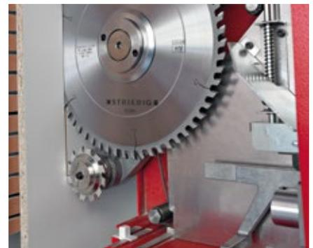
Zeit-, kosten- und werkzeugsparend – die Vorteile des Vorritzsägeaggregates VSA. Bei grösseren Mengen und einem evtl. niedrigen Qualitätsniveau der Platten ist das VSA ein „Muss“. Denn: Die Standzeit eines Hauptsägeblattes verlängert sich um das 7-8fache. Ein Vorritz-Sägeblatt übersteht mind. 3 Hauptsägeblätter.
