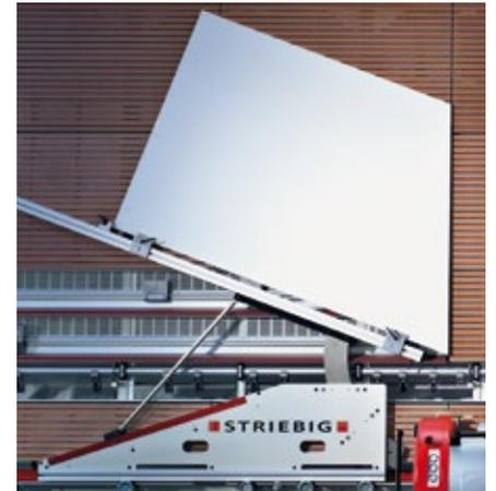
Das Winkelschnittgerät WSG kann links und rechts neben jeder vertikalen Schnittstelle eingesetzt werden. Es ist einfach und schnell montiert. Einsatzbereich: Platten bis 42 mm Stärke, exakte Winkel und Gehrungen von 0° - 46°.
