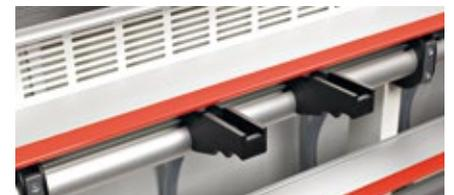
„High-End“-Raster aus faserverstärktem Kunststoff-Material bieten bei besonders empfindlichen Kantenmaterialien und Postforming-Kanten speziellen Schutz.
