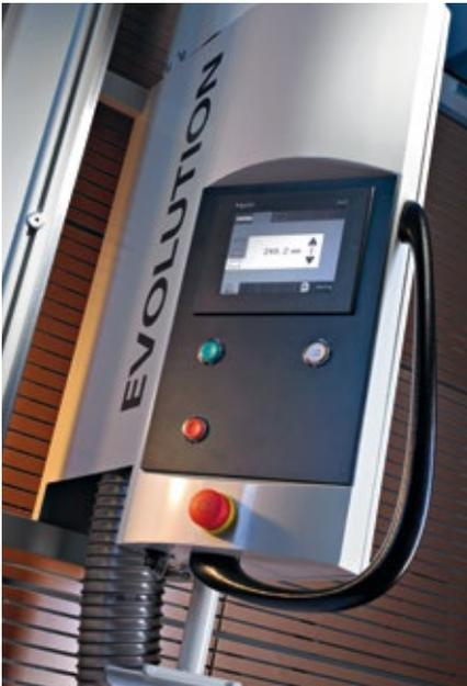
Bedienführung und Fehlererkennung sind mehrsprachig. Selbsterklärende Symbole führen durch das Menü. Es werden immer nur die Funktionen angezeigt, die möglich sind. Fehlbedienungen sind damit weitestgehend ausgeschlossen. Mit dem serienmässigen Betriebsstundenzähler erfassen Sie die Zeiten an der Säge.
