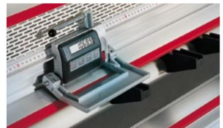
Digitales-Mess-System DMS für beide Achsen (serienmässig). Frei wählbare Anzeigegenauigkeit zwischen 1,0/0,5 und 0,1 mm.
