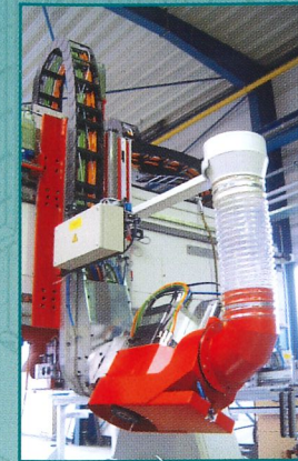
• Schwenkaggregat mit integrierter Vectorachse • swivel aggregate with integrated vector axis
