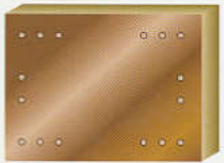
Foratura ortogonale al pannello con 13 mandrini a discesa indipendente
