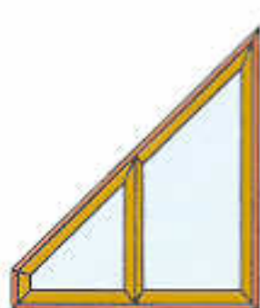
Esecuzione di cornici sagomate rettilinee e ad arco per il fissaggio del vetro Execution of shaped windows frames, linear and arched Ausführung von fassonierten, geradlinigen u. bogenförmigen Zargen
