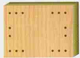
Foratura ortogonale al pannello con 13 mandrini a discesa indipendente Face boring with 13 independently lowering spindles Rechtwinklige Werkstückbohrung mit 13 unabhängig arbeitenden Spindeln
