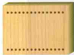
Foratura ortogonale al pannello con 13 mandrini a discesa indipendente Face boring with 13 independently lowering spindles Rechtwinklige Werkstückbohrung mit 13 unabhängig arbeitenden Spindeln
