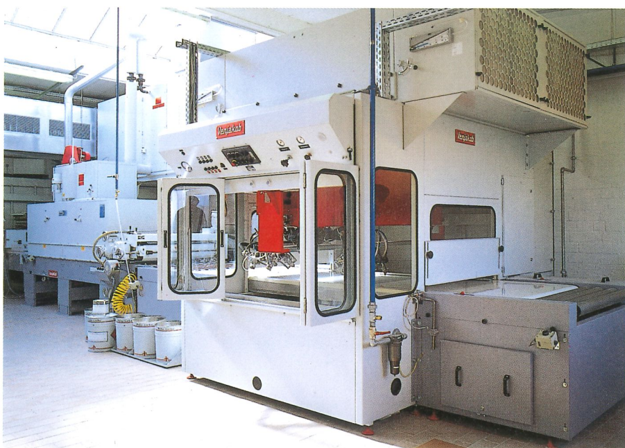
Lackieranlage mit nachfolgender Trocknung
