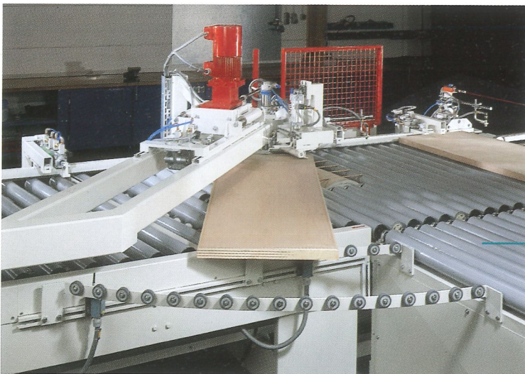
Drehvorrichtung kombiniert mit Kurbelschwinge und Konuskegel
