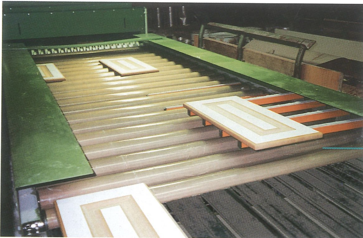
Rollen-transport mit Werkstück- umsetzstation von 1-spurig auf 2-spurig
