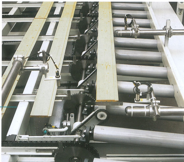
Werkstück-Vereinzlung durch Kurbelschwinge, vom Quersport mit Ausförderung in Längsrichtung
