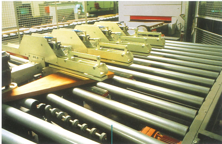
Wendestation für eine beidseitige Werkstück-Flächenbearbeitung
