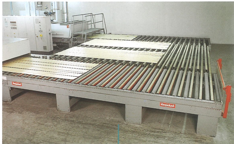
Rechen-Winkelübergabe 180°, eingesetzt als Werkstückrückführung
