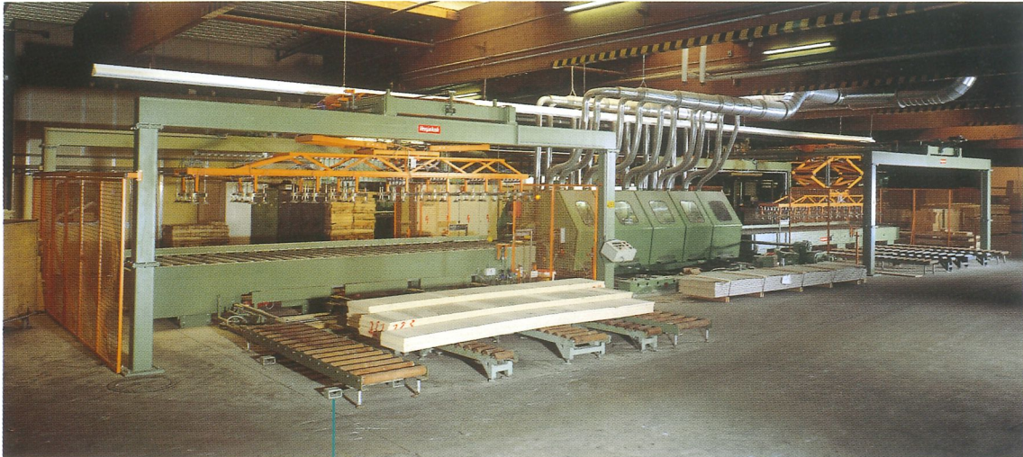
Beschickung und Abnahme durch Stapelanlagen für Großformate vor und nach einer Kantenbearbeitung
