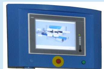
Ecran tactile 15" couleur avec console de commande
