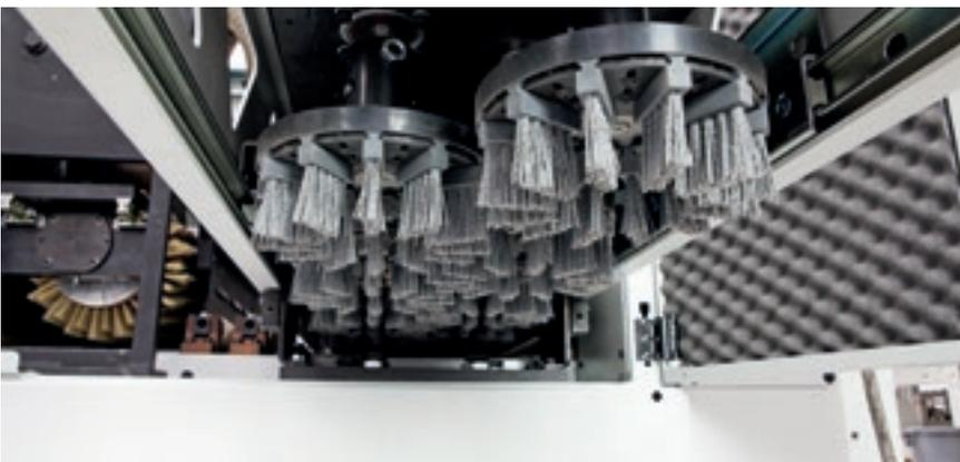
Die **Spinbrush Gruppe** ist die optimale Lösung zum Strukturieren, auch für Komponenten, die mit in verschiedenen Richtungen angeordneten Hölzern hergestellt sind: Das Abtragen des weichen Materials der Holzmaserung erfolgt gleichmäßig in alle Richtungen, auch dank der Schwingung des Werkzeugs, die eine außergewöhnliche Ho-
