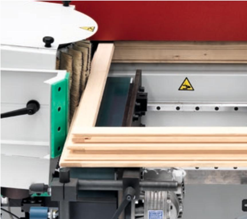
Die **Gruppe mit vertikalen Bürsten Win** ist ein Feinschleifsystem mit senkrechten rotierenden Bürsten. Mit dieser Einheit können die Profile und die seitlichen Flächen des Werkstücks durch Bürsten feingeschliffen werden, wodurch Glätte und Homogenität
