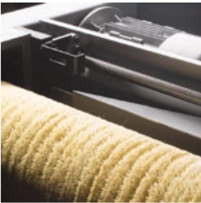
Die **Bürste zur Plattenreinigung** kann mit Borsten aus unterschiedlichem Material versehen werden, um den höchsten Ansprüchen an die Sauberkeit der bearbeiteten Platten zu genügen.
