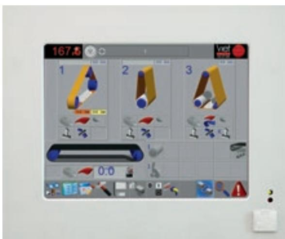
IPC 是一系列集成在设备上的触摸屏控制系统。此控制系统可管理设备的所有参数，为操作者提供及时直观的信息。
