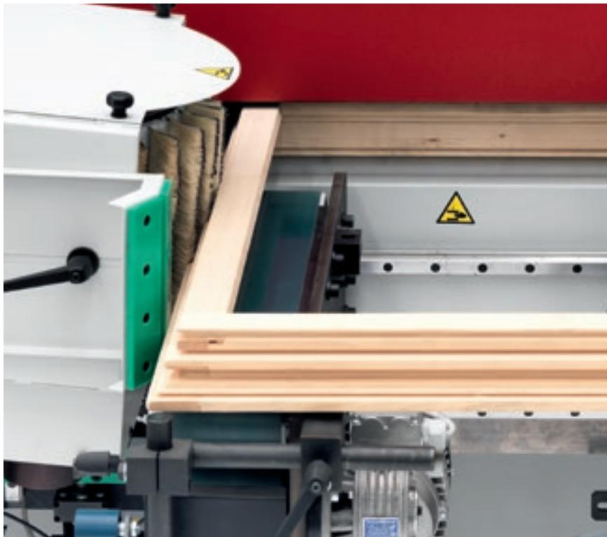
装有刷辊的设备是一台垂直旋转刷辊砂光系统。客户可使用该设备通过砂光横截面及侧面，确保成品的平滑度。
