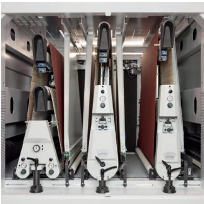
Opera 5 可配置定厚工作单元及直径300 mm 的软橡胶砂光辊及/或超级砂光面板工作单元等,成为一台多功能砂光中心,以满足多样化的加工需求。
