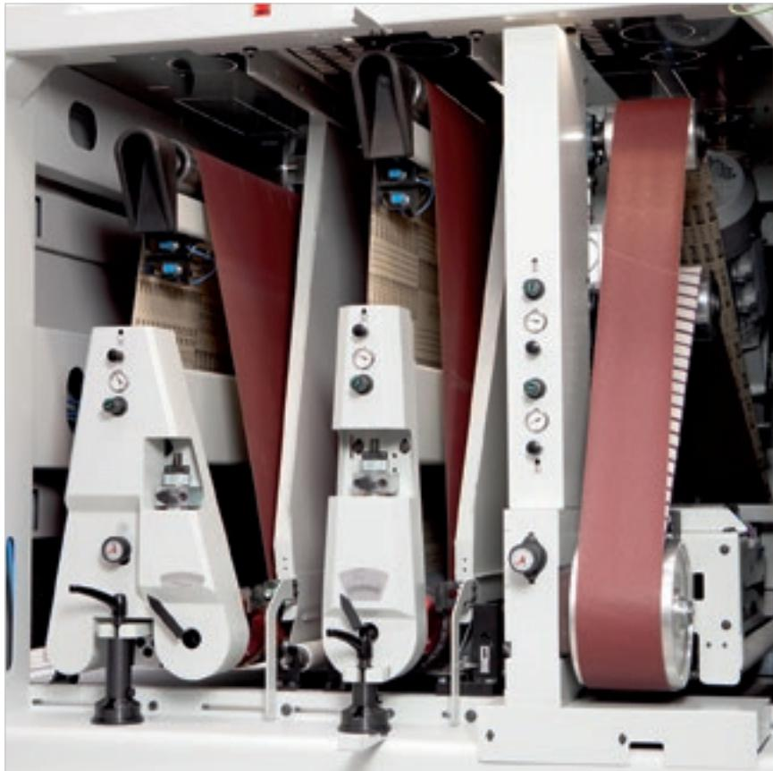
Opera 5 拥有2到4个工作单元及横向工作单位,电子枕工作位、成品工作位及可在任一工位配置的砂光刷等,这些配置使其成为高品质的砂光中心。
