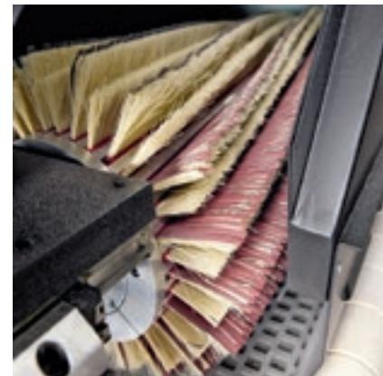
长刷辊配置了交叉片段式振动系统，稳固而可靠，同时使用控制面板的电子化控制界面来管理加工流程，带来高品质的加工成品。磨料可快速更换，无需把工作单元从机器内取出。300或 400 mm 横截面磨料适用。
