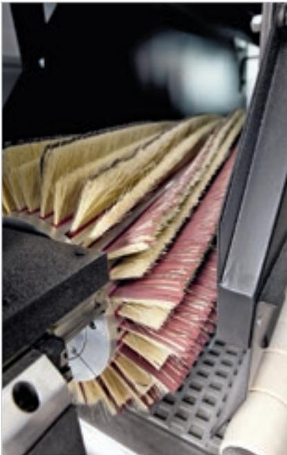
Robuste et fiable, la **brosse longitudinale** est munie du système d'oscillation transversale pour uniformiser la qualité de finition sur l'objet et de réglage d'interférence électronique actionnable depuis le tableau de commande. Les poils abrasifs peuvent être rapidement remplacés sans devoir extraire le groupe de la machine. Brosse à inserts abrasifs de 300 ou 400 mm de diamètre.
