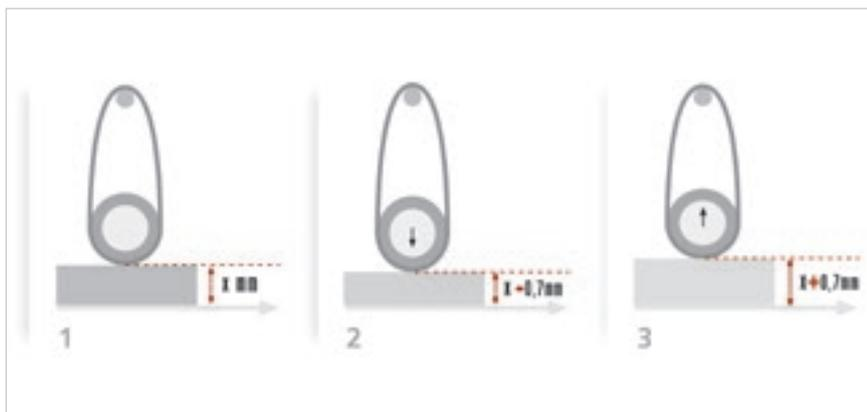
Le **groupe Rouleau à technologie HP (High Performance)**, permet de façonner des panneaux de différentes épaisseurs sans devoir varier la cote de travail. Cette solution réduit les temps de paramétrage de la machine et garantit une finition constante également sur des lots de panneaux caractérisés par des différences d'épaisseur allant jusqu'à 1,4 mm.
