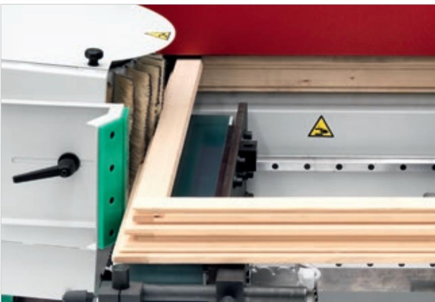
Le **Groupe à brosses verticales win** est un système de ponçage à brosses verticales rotatives. L'unité permet de poncer, en brossant, les profils et les surfaces latérales de l'objet afin de garantir finition et homogénéité. Chaque groupe, équipé de brosses de grand diamètre (300 ou 400 mm), peut être réglé de manière indépendante en termes de position latérale, d'inclinaison (-10° +35°) et de hauteur.
