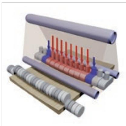
Le **tampon électronique à technologie HP (High Performance)** permet d'améliorer les résultats du façonnage aussi bien en termes de planéité que de finition.
