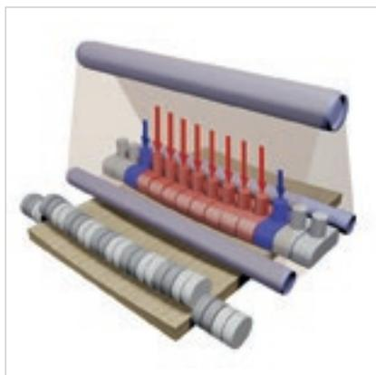
El **tampón electrónico con tecnología HP (High Performance)** potencia los resultados del mecanizado, tanto en planaridad como en acabado.
