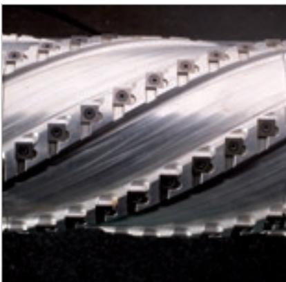
El **grupo HPG** se recomienda en el calibrado de paneles alistonados, y permite extraer varios milímetros en una sola pasada.
