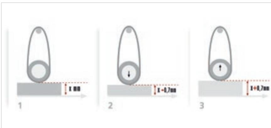
El **grupo de Rodillo con tecnología HP (High Performance)** permite mecanizar paneles con diferencias de espesor sin tener que variar por ello la cota de trabajo. Dicha solución reduce los tiempos de ajuste de la máquina y garantiza un acabado constante incluso en lotes de paneles con diferencias de espesor de hasta 1,4 mm.
