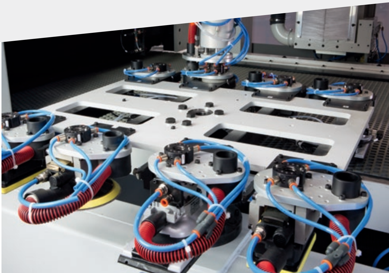
Stazione porta utensili a 8 postazioni per un rapido cambio utensile automatizzato in tempo mascherato.
