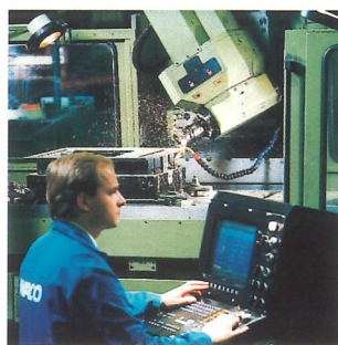
Bearbeitung in einer 5-achsiger Fräsmaschine.
