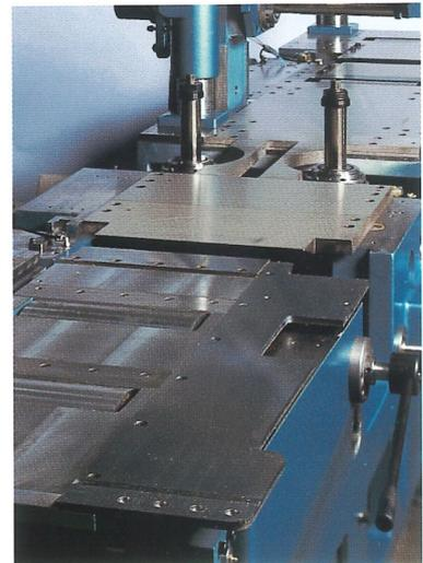
Gehärtete Tischplatten. Gegenüberliegende Vertikalspindeln: Garantie für höchste Massgenauigkeit.
