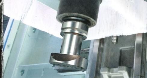
9 kW HSK-Frässpindel 24000 min<sup>-1</sup>
