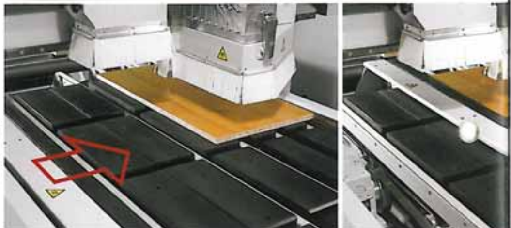
Ausrichten des Werkstücks mittels pneumatischer Spannwanne gegen das Anschlaglineal
