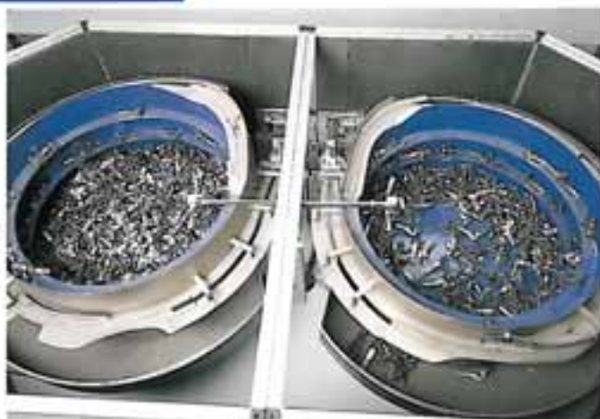
Automatische Sortier- und Zuführeinrichtung für zwei Sorten Topfbandschmiere
