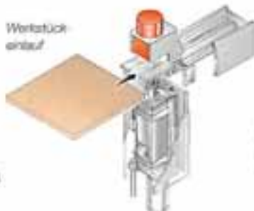
Spannen des Werkstücks von oben
