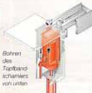
Einsetzen des Topbandscharniers aus dem Magazin
