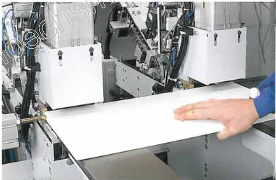
Manuelles Auflegen einer Front am linken Maschinenanschlag
