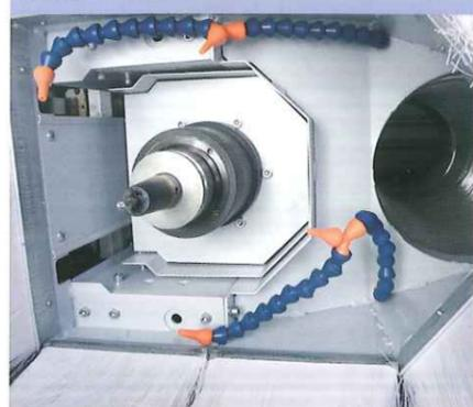
Standard: 9 kW HSK-Frässpindel
