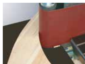
Schleifen an der Bandspannwalze oder Rundschleifeinrichtung.
