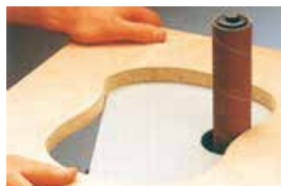
Rundschleifeinrichtung mit Zusatzstisch, Schleifdorn und Gummwalzen Ø 30, 40, 50, 60 mm (Option)
