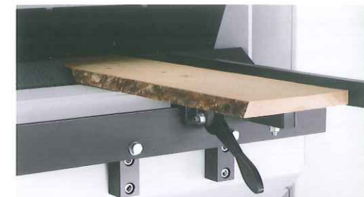
Einlauflineal: ideal für Verarbeitung von besäugtem Holz
