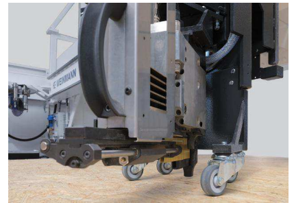
Fijación del revestimiento
