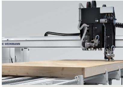
Fijación del revestimiento
