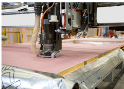
Obróbka płyt kartonowo-gipsowych
