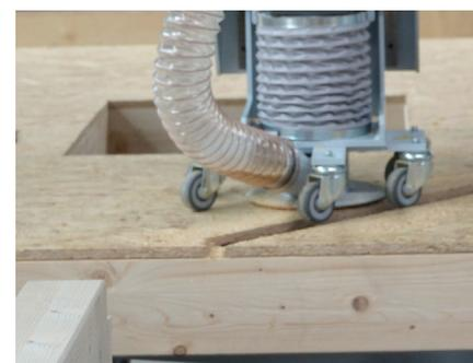
**Automatisches Befestigen** der Beplankung mit Hilfe des Klammergeräts.
