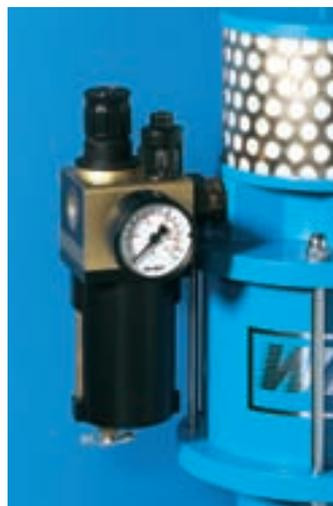
Das Vereisen des Luftmotors wird durch eine angebaute **Wartungseinheit** weitgehend verhindert.
