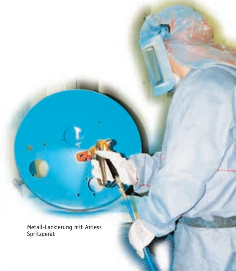
Metall-Lackierung mit Airless Spritzgerät
