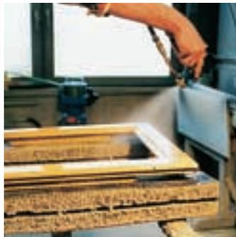
Holzfenster-Lackierung mit Air Combi Lackiergerät
