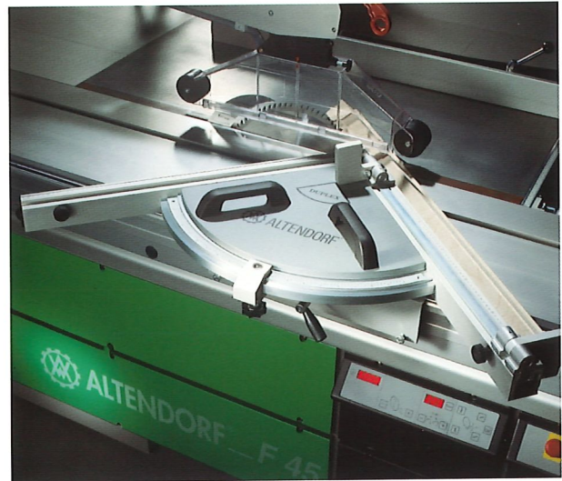
DUPLEX-Anschlag , einstellbar über Maßskala
