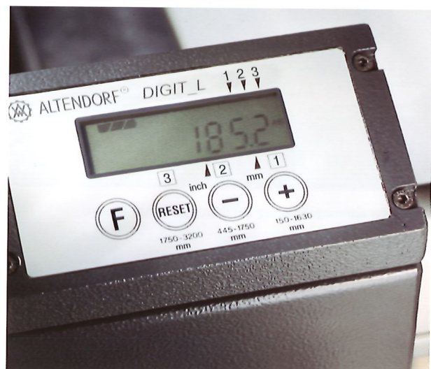
Einfacher Eichvorgang und Anwählen der Anschlagklappen über Tastatur.
