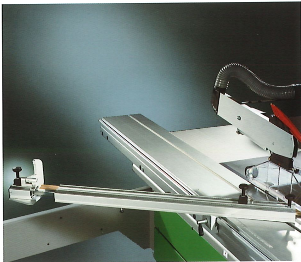
Einseitiger Gehrungsanschlag mit schräggestellten Skalen.
