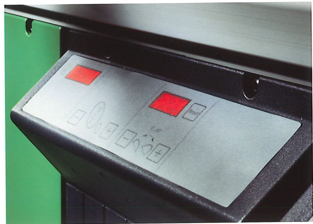
Multi-Funktions-Paneel mit elektronischer Höhen- und Schwenkverstellung des Sägeaggregats und digitaler Schwenkwinkel- und Drehzahlanzeige.
