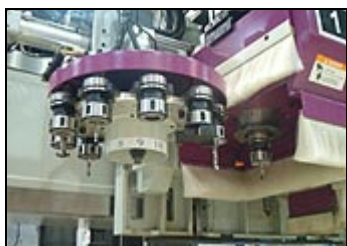
Mitfahrende Werkzeugmagazine. Bis zu 12 Plätzen PMM Servogesteuert.
