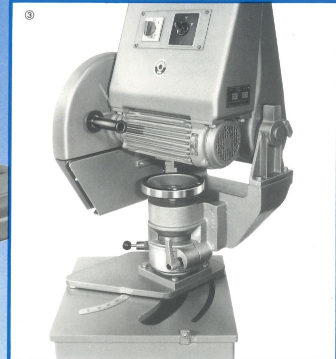
Schwenkbereich von 0°–45° für alle Gehrungswinkel mit Winkelskala und selbsttätige Arretierung in der 0-Stellung.
