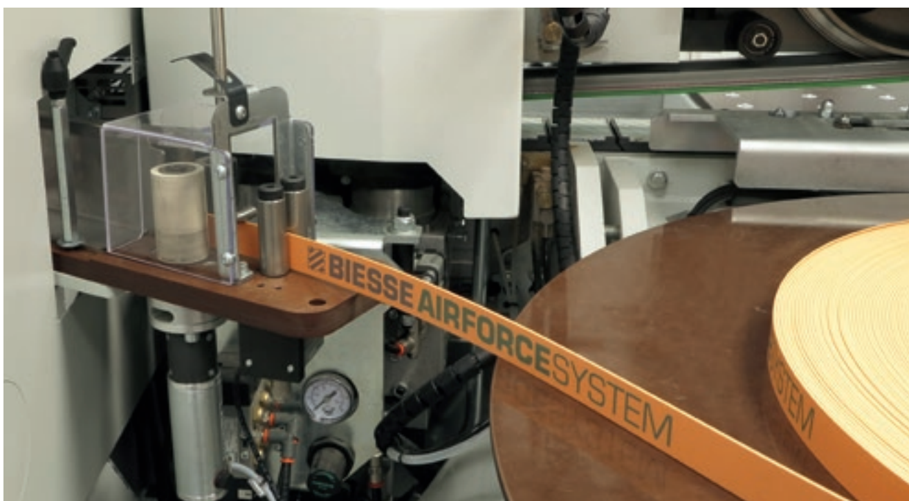
Cargador automático mono rotor que permite cambiar rápidamente el canto sin necesidad de abrir las cabinas. Sensor óptico para detectar el posicionamiento correcto de la placa (opcional).
