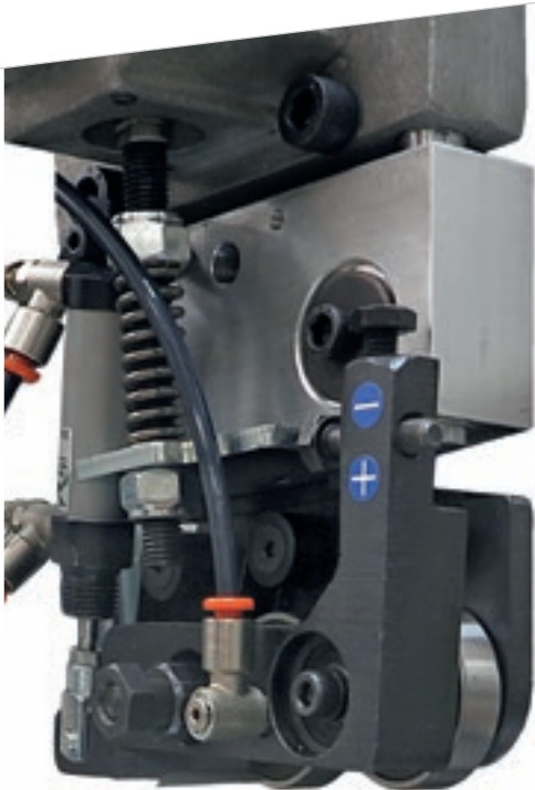
Unidad de cepillos para la limpieza y el pulido del canto y del panel.
