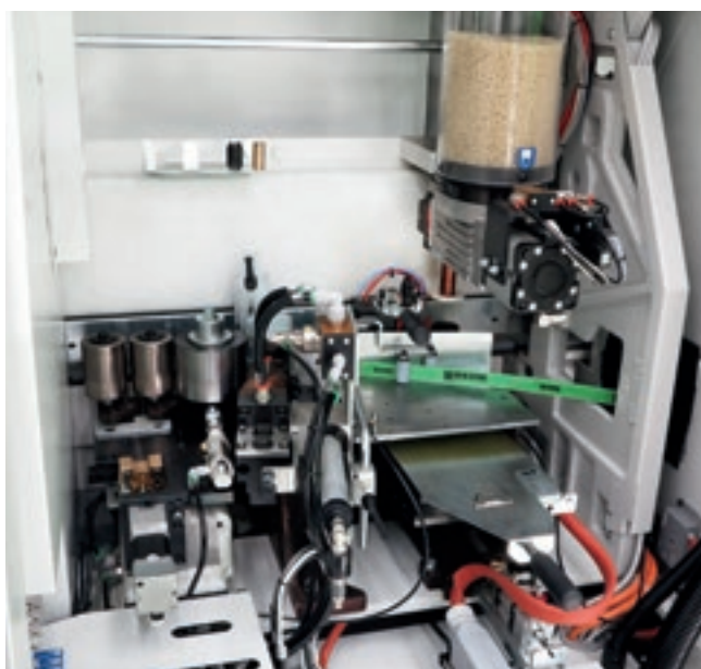
Groupe de collage pour l'application automatique de chants en bobines et en bandes de 0,4 à 12 mm.
