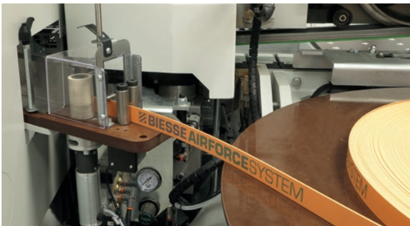
Dépilleur automatique depuis rouleau unique , qui permet le changement rapide du chant sans devoir ouvrir les cabines. Capteur optique pour la détection du positionnement correct du chant (opt.).
