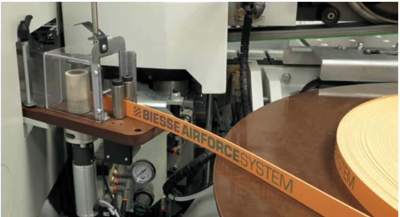
Автоматический загрузчик на один рулон кромки позволяет производить быструю смену кромки без необходимости открывать кабины. Оптический датчик для считывания корректного положения кромки (опция).
