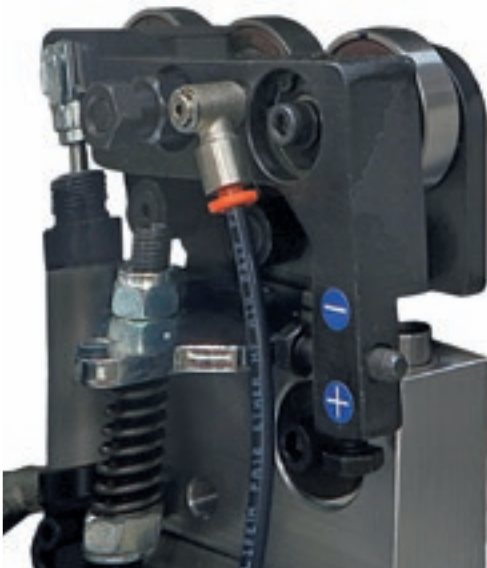
Группа клеевого скребка для удаления избыточного клея из верхней и нижней поверхностей панели, единственная на рынке, имеющая 4 пневмоцилиндра для высокого качества отделки.
