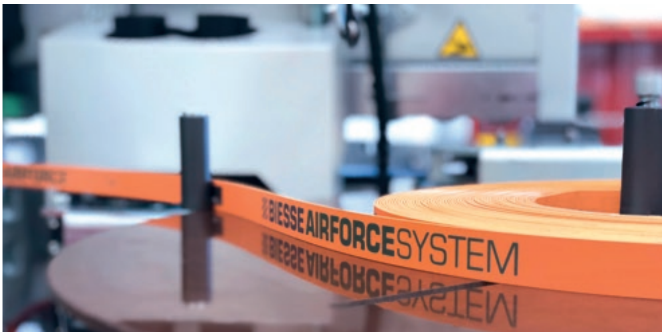
Dépilleur automatique depuis rouleau unique , qui permet le changement rapide du chant sans devoir ouvrir les cabines. Capteur optique pour la détection du positionnement correct du chant (opt.).
