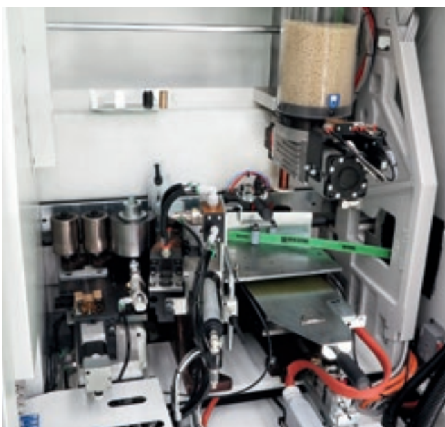
Gruppo Incollatore per l'applicazione automatica di bordi in rotolo e strisce da 0,4 a 12 mm.
