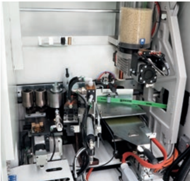
Клеевая группа для автоматического нанесения кромки в рулонах или полосках, толщиной от 0,4 до 12 мм.
