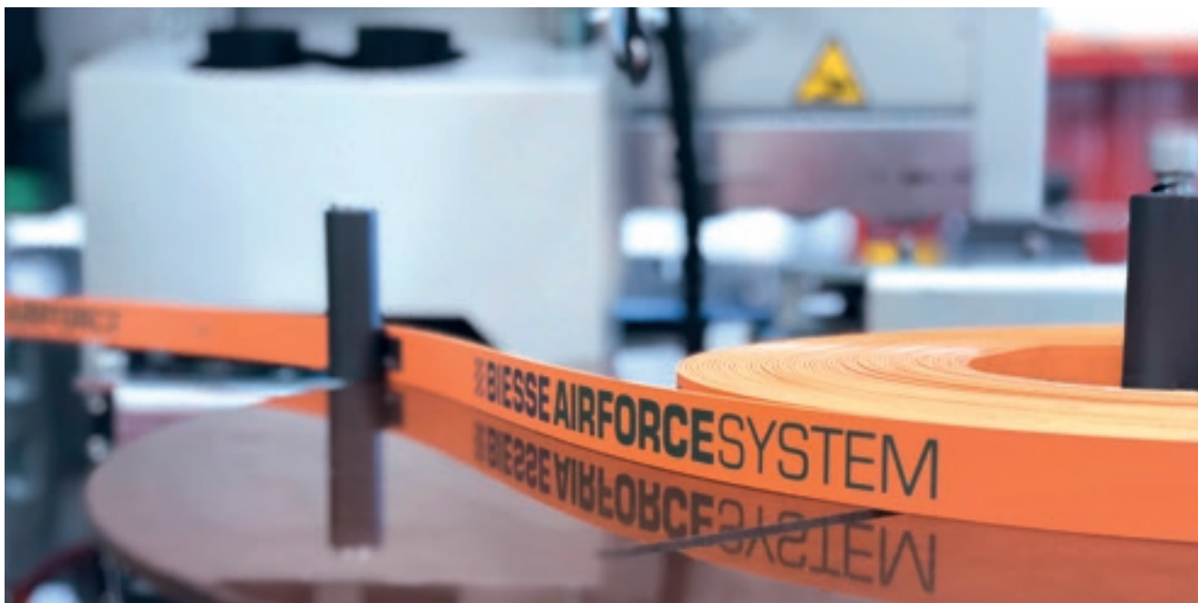
Автоматический загрузчик на один рулон кромки позволяет производить быструю смену кромки без необходимости открывать кабины. Оптический датчик для считывания корректного положения кромки (опция).
