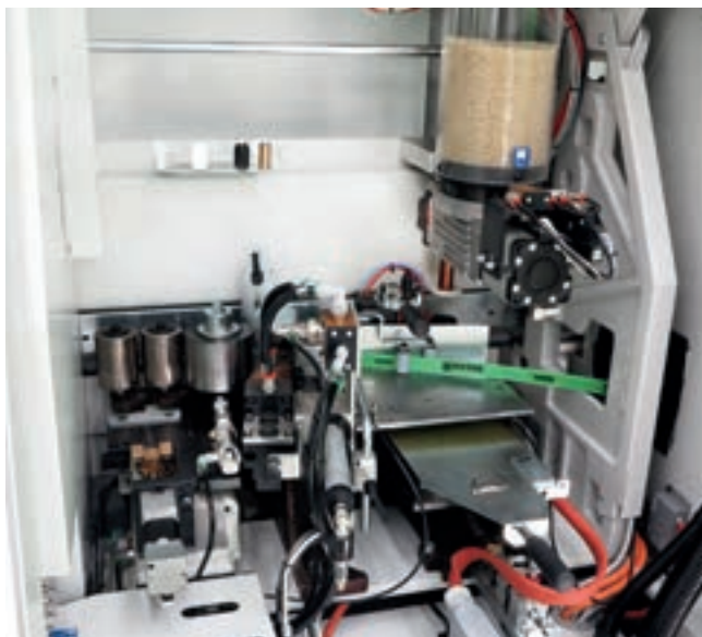
Gruppo Incollatore per l'applicazione automatica di bordi in rotolo e strisce da 0,4 a 12 mm.
