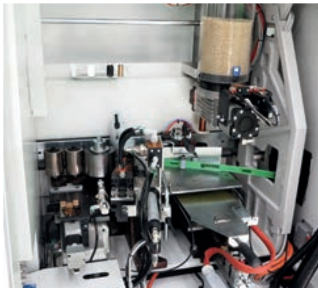
Grupo de cola para a aplicação automática de orlas em rolo e fitas de 0,4 a 12 mm.
