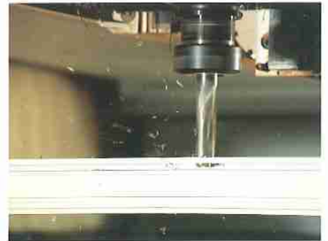
Schneiden / Bearbeiten von Alu- oder Alucobondplatten (mit Kühlung)
