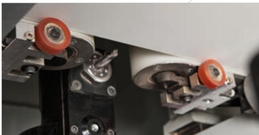
Патентованная система подачи с двойной станцией для обработки 4 боковых сторон панели без каких-либо ограничений (не устанавливается на Vektor 25 и 30).
