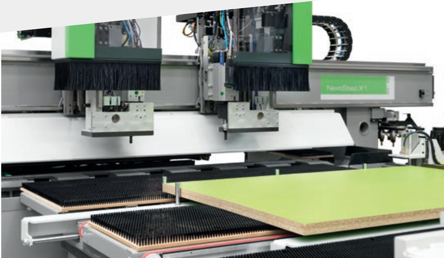
La rígida estructura de Nextstep garantiza la ausencia de vibraciones durante la ejecución del mecanizado para lograr productos acabados perfectos.
