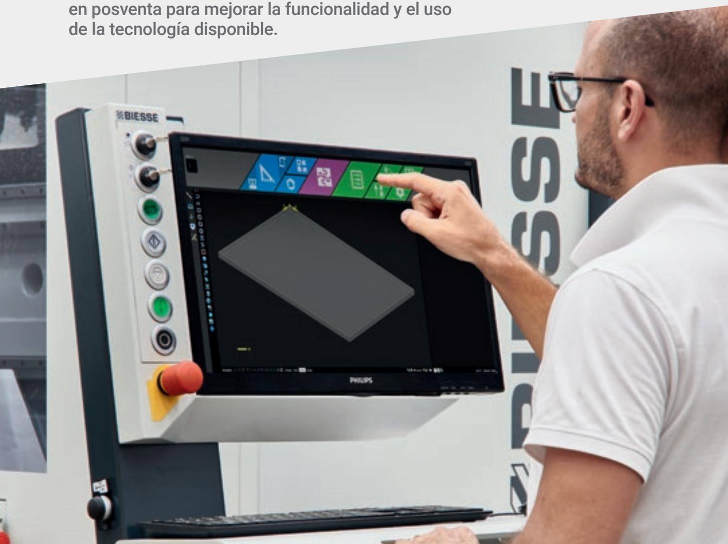
**bTouch es la nueva pantalla táctil de 21,5" que permite realizar todas las funciones efectuadas por el ratón y por el teclado garantizando una interactividad directa entre el usuario y el dispositivo.**
