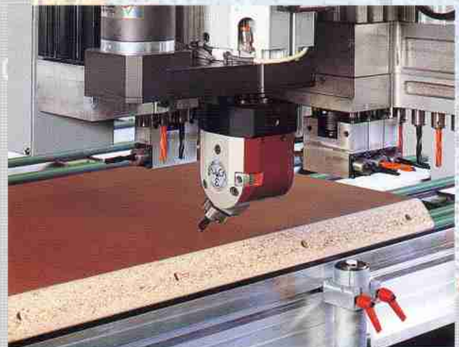
Tilted assembly holes. Verbindungsbohrungen unter jedem Winkel
