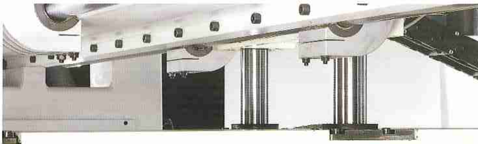
11A: System 32 vertical borings carried out with the two independent operating units Vertikale Bohrungen System 32, mit den 2 unabhängigen Arbeitseinheiten durchgeführt
