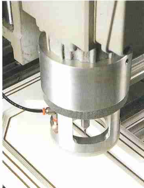
9E: Router equipped with mechanical copier Fingerfräser mit mechanischem Kopierer
