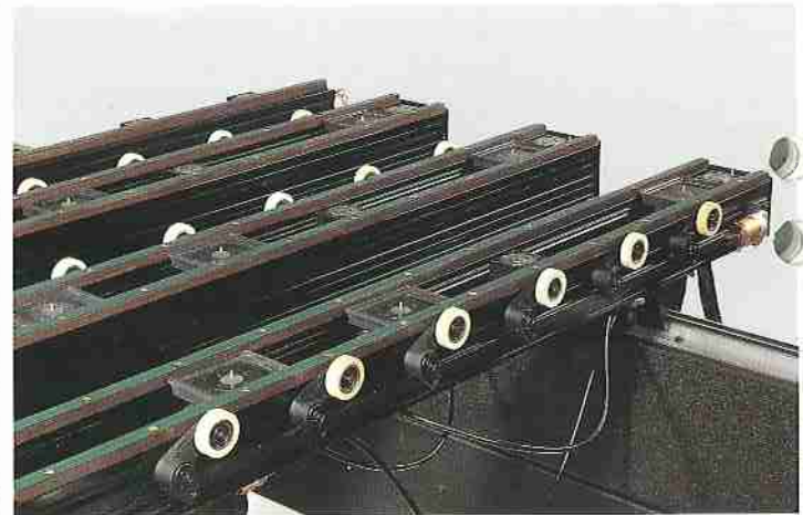
6F: N.C. positioning of the panel supports 6E: NC-gesteuerte Positionierung der Werkstückauflagen
