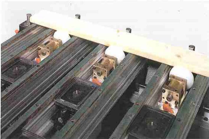
7A: Manual front pushers for the clamping of narrow pieces Manuell positionierte Rückanschläge zum Spannen schmaler Teile
