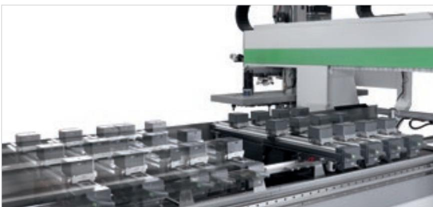
**EPS (Electronic Positioning System)** Ermöglicht es den gesamten Arbeitsbereich automatisch und schnell neu zu konfigurieren. Das System positioniert die Werkstückauflagen und Sauger mittels unabhängiger Motoren, d.h. ohne Einsatz der Arbeitseinheit. Die Positionierung von Werkstückauflagen und Saugern eines Bereichs wird ohne Totzeiten durchgeführt, während die Maschine auf der anderen Seite arbeitet.
