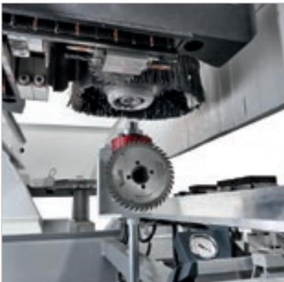
Der **Pick Up Platz** gestattet die Bestückung der Werkzeugwechsler in der Maschine.
