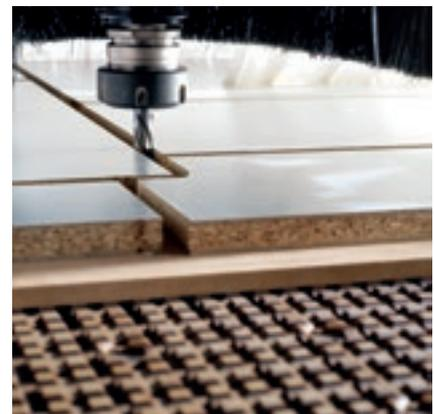
Zwei Maschinen in einer: Alle Funktionen und die Qualität einer echten Flachtischmaschine werden durch das **CFT-System (Convertible Flat Table)** gewährleistet und ermöglichen so Bearbeitungen von dünnen Platten, Nesting oder Folding auf einer Konsolenmaschine.
