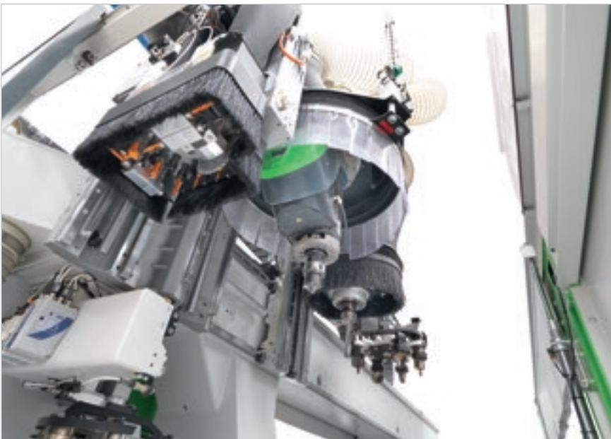
Eine Konfiguration, die den Ansprüchen der flexiblen Produktion ohne Verzicht auf eine hohe Serienproduktion entspricht. Die Gruppen-Kombination 5 Achsen und 4 Achsen ermöglicht die Bearbeitung aller Arten von Produkten.
