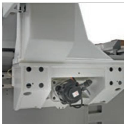
Der **doppelte Antrieb entlang der X-Achse** ermöglicht das Erreichen hoher Drehzahlen und Beschleunigungen, wobei hohe Präzision und Oberflächenqualität beibehalten werden.
