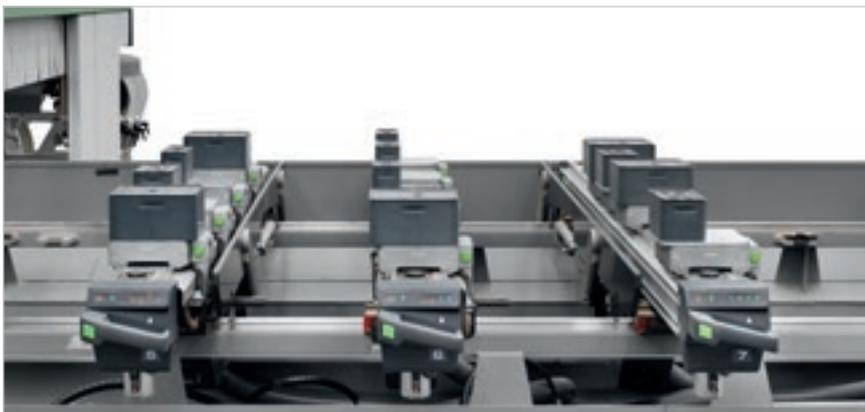
Der Arbeitstisch mit unterstützter Positionierung gibt dem Bediener an, wie die Platte anzuordnen ist (Angabe der Positionen für Arbeitstisch und Aufspannsysteme) und schützt den Arbeitsbereich vor etwaigen Kollisionen mit dem Werkzeug.
