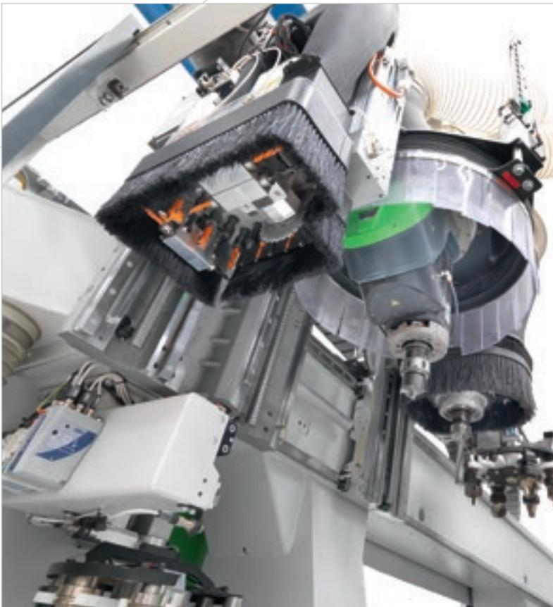
Technologische Lösungen, die entwickelt wurden, um auf die Ansprüche der flexiblen Produktion ohne Verzicht auf die Produktivität zu antworten. **Unabhängige Y-Achsen** zur Durchführung von Werkzeugwechseln an der Bearbeitungseinheit X unter Verwendung der größten Zahl in der Maschine verfügbarer Werkzeuge ohne Auswirkungen auf die Zykluszeiten.
