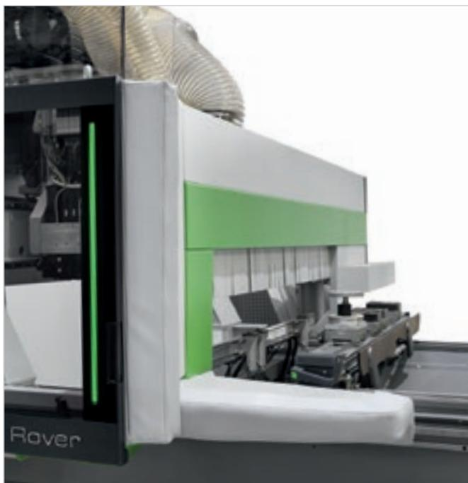
**Sicurezza e flessibilità grazie ai nuovi bumper abbinati alle fotocellule senza ingombro a terra con pendolare dinamico.**
