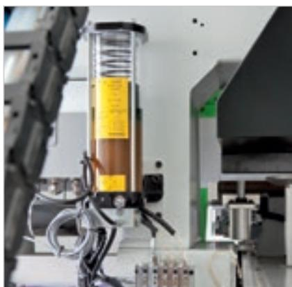
La **lubrificazione automatica** garantisce una continua lubrificazione dei principali organi di movimentazione della macchina senza richiedere l'intervento dell'operatore.
