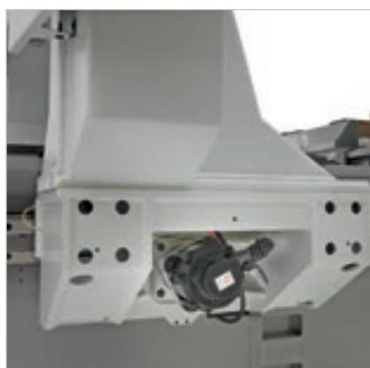
La **doppia motorizzazione nell'asse X** permette di raggiungere elevate velocità e accelerazioni mantenendo un'alta precisione e qualità di finitura.
