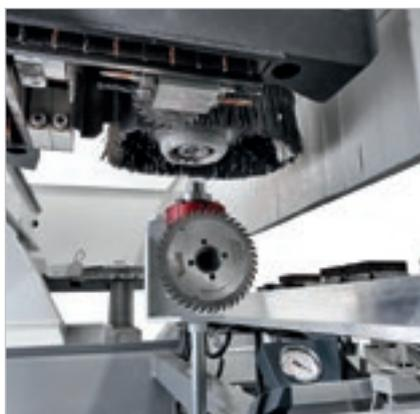
Il **Pick Up** permette di attrezzare i magazzini a bordo macchina.
