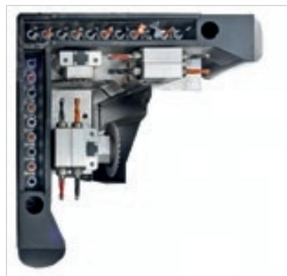
La nuova **testa a forare BH30 2L** è dotata di lubrificazione automatica e aspirazione in metallo per una maggiore durata nel tempo, raffreddata a liquido per garantire la massima precisione.
