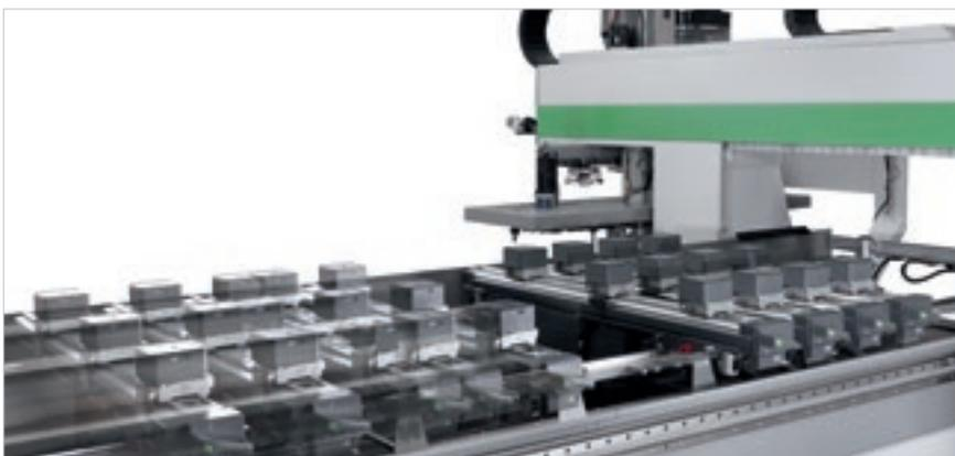
EPS (Electronic Positioning System - Электронная система позиционирования) позволяет автоматически быстро конфигурировать всю рабочую зону. Позиционирует столы и каретки при помощи независимых приводов, не занимая, таким образом, рабочую группу. Позиционирование столов и кареток зоны выполняется в скрытое время в то время, когда станок работает в противоположной зоне.
