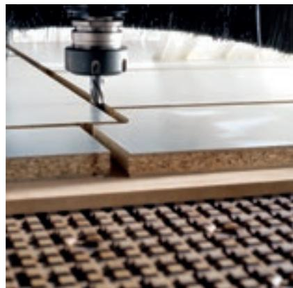
Два станка в одном: все функции и качество настоящего стола пантографа обеспечиваются CFT (Convertible Flat Table), позволяя осуществлять обработку тонких панелей, обработки по технологии nesting и folding на одном станке со столом с планками.
