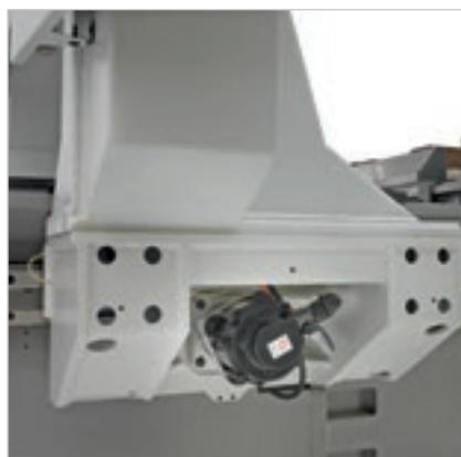
Двойной привод по оси X позволяет достигать больших скоростей и ускорений при сохранении высокой точности и качества отделки.
