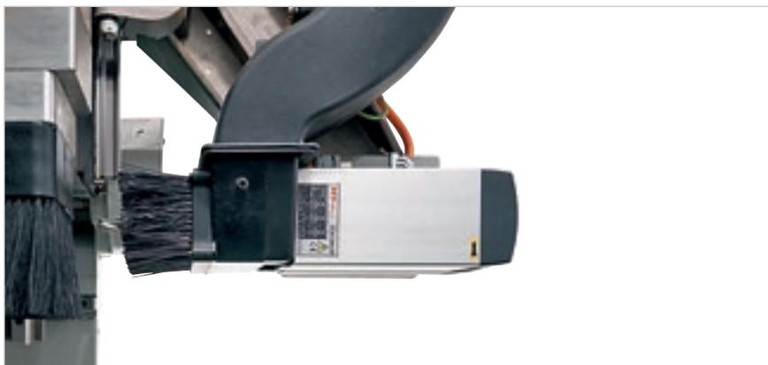
Горизонтальный двигатель с 1 или 2 выходами предназначен для выполнения выборки под замок и горизонтальных обработок.
