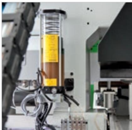
Автоматическая смазка обеспечивает непрерывную смазку основных систем перемещения станка без необходимости вмешательства оператора.
