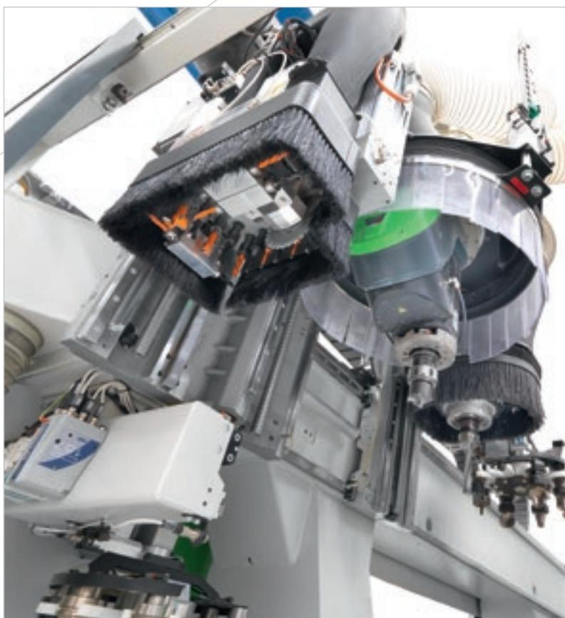
Технологические решения разработаны для удовлетворения потребностей в производственной гибкости при сохранении производительности. Независимые оси Y для выполнения смен инструментов на каретке X с использованием большего количества доступных инструментов на станке, не увеличивая время цикла.
