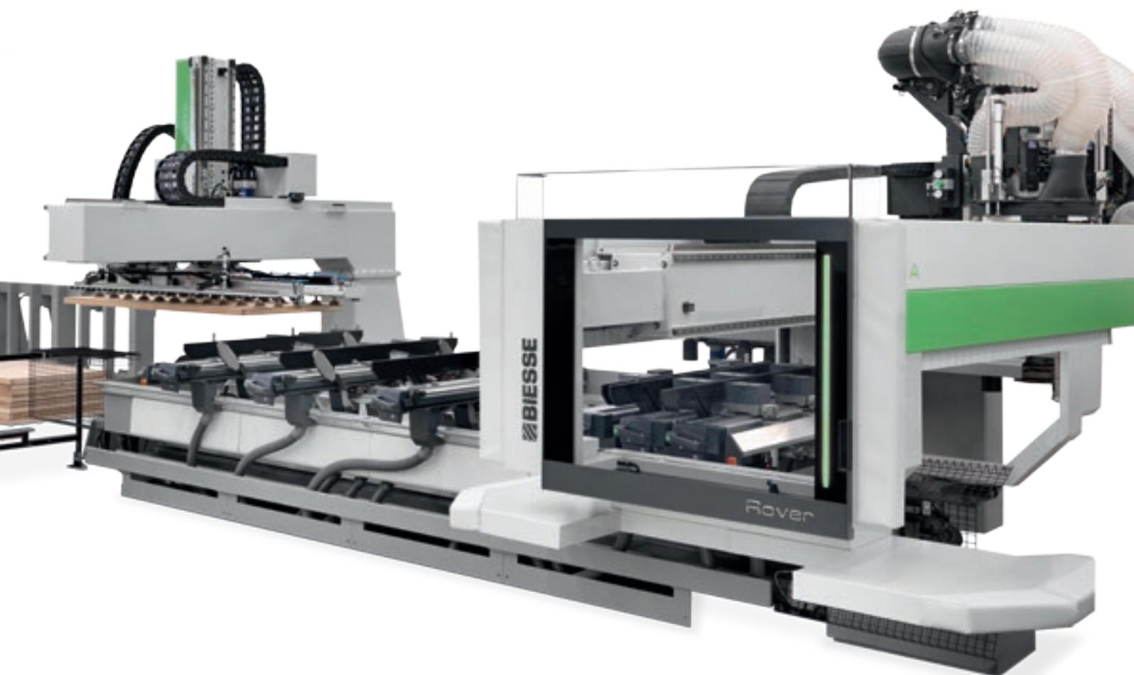
**Synchro способен обрабатывать стопы панелей различных размеров благодаря устройству для базирования стопы и циклу предварительного выравнивания панели, что осуществляется за скрытое время, пока обрабатывающий центр Rover производит обработку предыдущей панели.**
