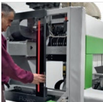
Простой доступ при выполнении операций оснащения благодаря открываемому переднему кожуху.
