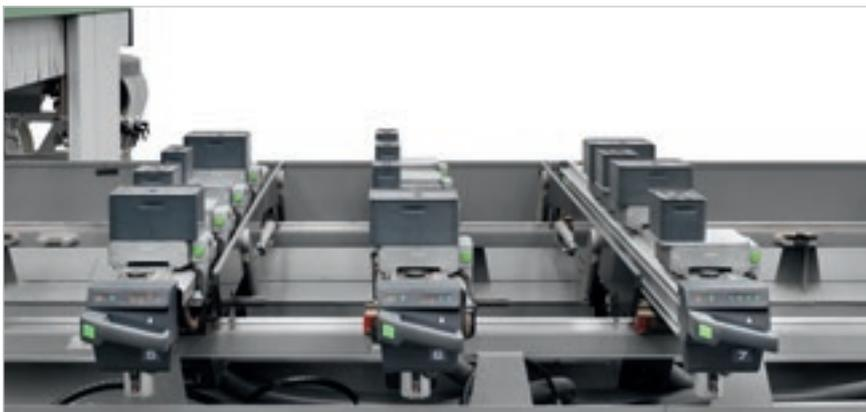
SA (Set Up Assistance - Помощь в настройке) Рабочий стол с помощью в позиционировании предлагает оператору способ установки панели (указывая положение рабочих столов и систем фиксации) и защищает рабочую зону от возможных столкновений с инструментом
