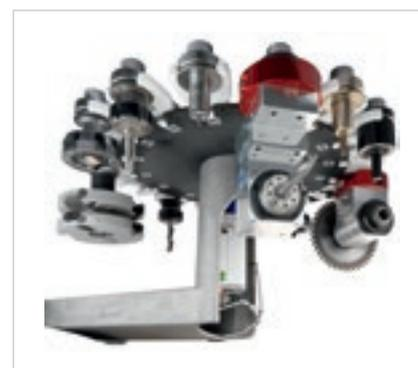
При переходе от одной обработки к другой оператор не должен выполнять операций по оснащению благодаря большому количеству инструментов и агрегатов, имеющихся на станке.
