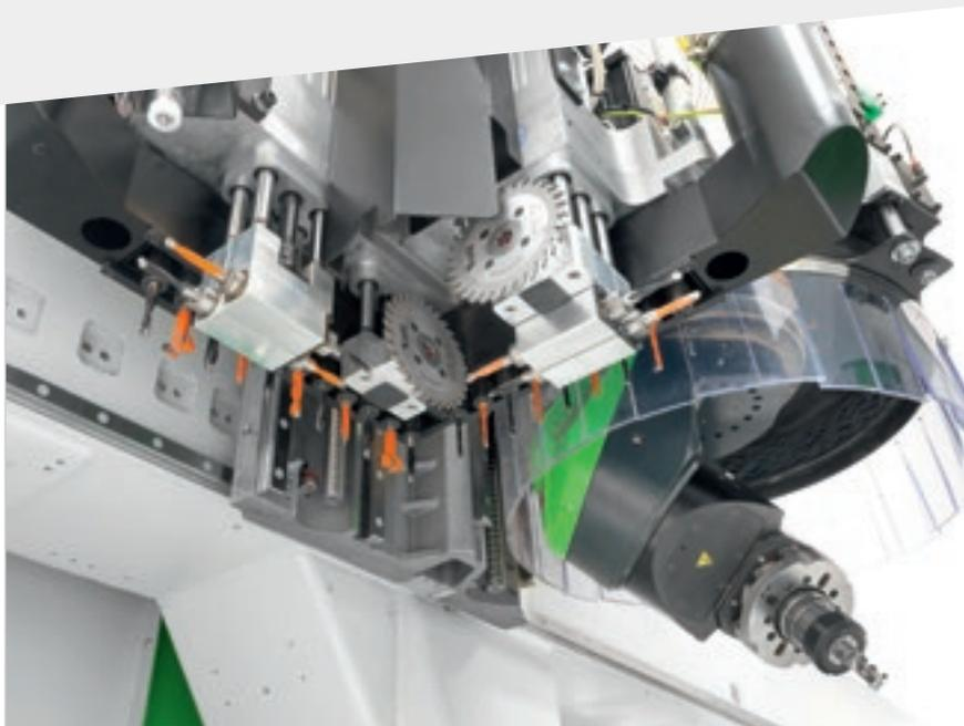
Компактность пятиосевой группы в сочетании с высокой производительностью сверления, которая может варьироваться в широком диапазоне: от простых до сложнейших обработок.
