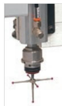
**Крестовидный щуп** позволяет с максимальной точностью считывать размеры панелей.
