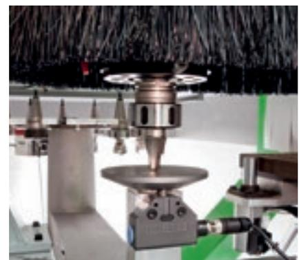
Réduction des temps d'outillage machine sans erreurs de la part de l'opérateur grâce au Présélecteur à contact qui permet de mesurer automatiquement la longueur de l'outil.
