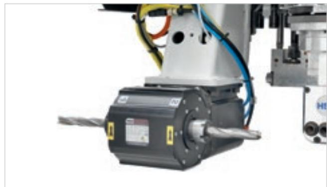
**Moteur horizontal à 2 sorties** refroidi par liquide. Également disponible dans la version à inclinaison par contrôle numérique pour les façonnages horizontaux, inclinés et verticaux.
