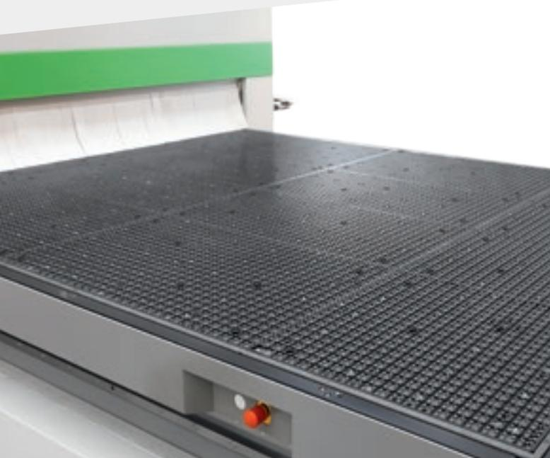
Technologie multizone qui adapte automatiquement le vide de la machine pour les différentes tailles du panneaux que le client a dans sa production.
