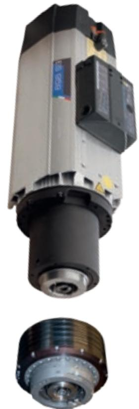
**Nouvel axe C Torque** : à système Direct Drive. L'absence d'engrenages assure une précision, une fiabilité et une rapidité d'exécution maximales. La rotation à 360° en continu et la possibilité d'interpoler permettent d'exécuter des pièces aux formes complexes.
