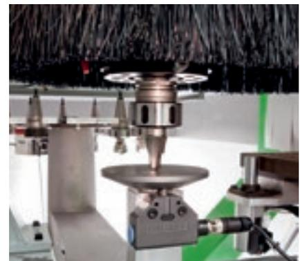
Сокращение времени оснащения станка без ошибок со стороны оператора благодаря **Контактному измерителю**, который позволяет производить автоматическое измерение длины инструмента.
