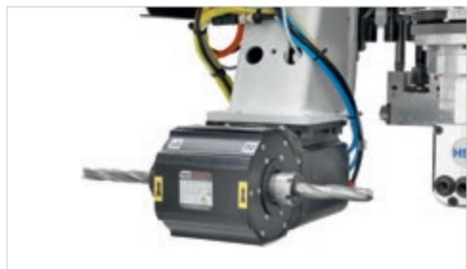
**Горизонтальный двигатель с 2 выходами** с жидкостным охлаждением. Может также поставляться в версии с наклоном по команде ЧПУ для горизонтальной, наклонной и вертикальной обработки.
