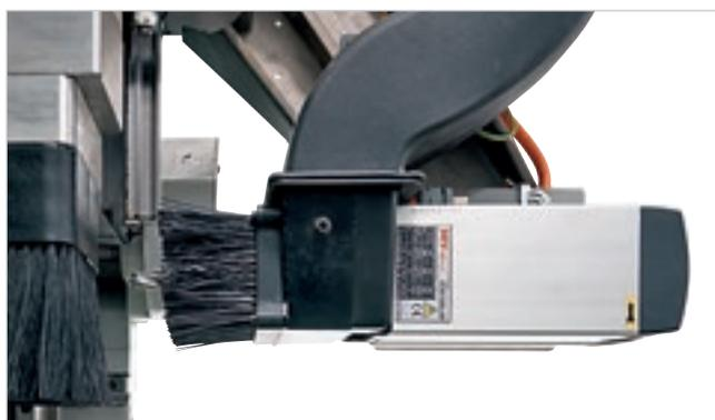
**Горизонтальный фиксированный двигатель** для вырезов под замки.
