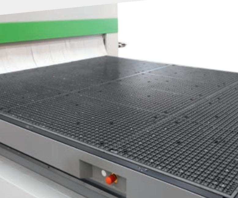
Технология Мультизоны для концентрации вакуума в маленькой зоне рабочего стола для фиксации деталей минимальных размеров.
