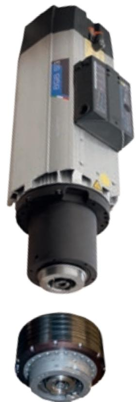
Новая ось **C Torque**: с системой Direct Drive. Отсутствие шестеренчатых передач дает максимальную точность, скорость и надежность. Бесконечное вращение на 360° и интерполяция для обработки деталей сложной формы.
