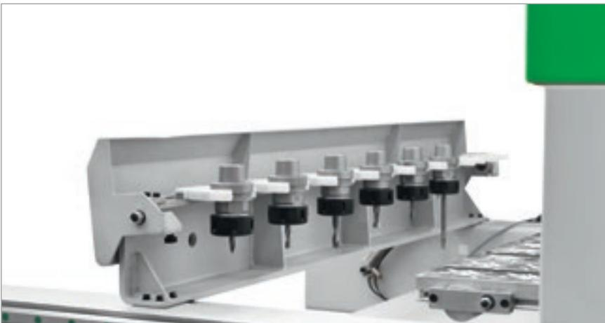
Kurze Bearbeitungszeiten dank des Werkzeugwechselmagazins mit 7 (Rover J FT 1224) oder 8 (Rover J FT 1530) Aufnahmen.
