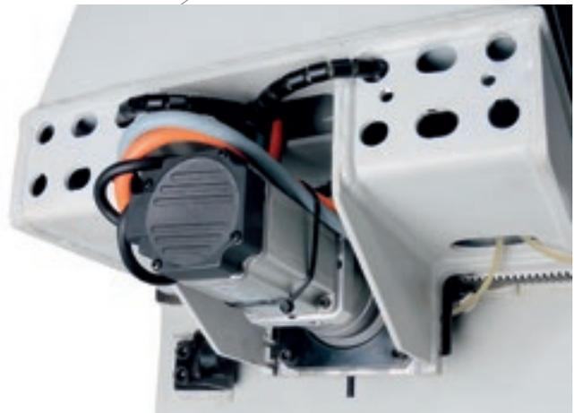
Der doppelte Antrieb entlang der X-Achse unterstützt das Erreichen hoher Drehzahlen und garantiert eine hohe Präzision und Feinbearbeitungsqualität.
