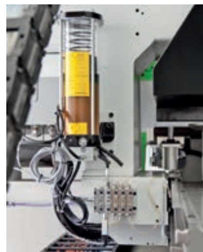
La lubrification automatique est une option qui garantit la lubrification continue des principaux organes d'actionnement de la machine sans l'intervention de l'opérateur.
