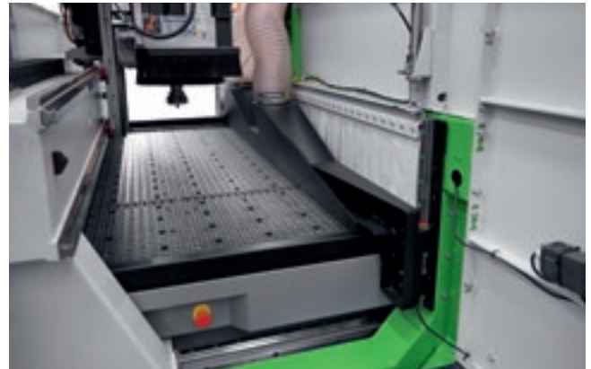
清扫臂与吸盘集成,在下料的同时清洁板件,避免了人工干预,从而提高了生产效率。
